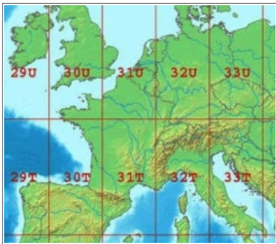
La projection cylindrique transverse permet la tangence d'un cylindre de projection avec 60 méridiens. La Terre est ainsi découpée en 60 tranches appelées "fuseaux".
